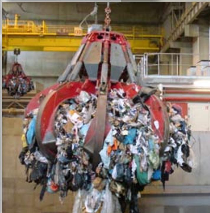
Polipi elettroidraulici per movimentazione di rifiuti solidi urbani e materiali a bassa densità.
