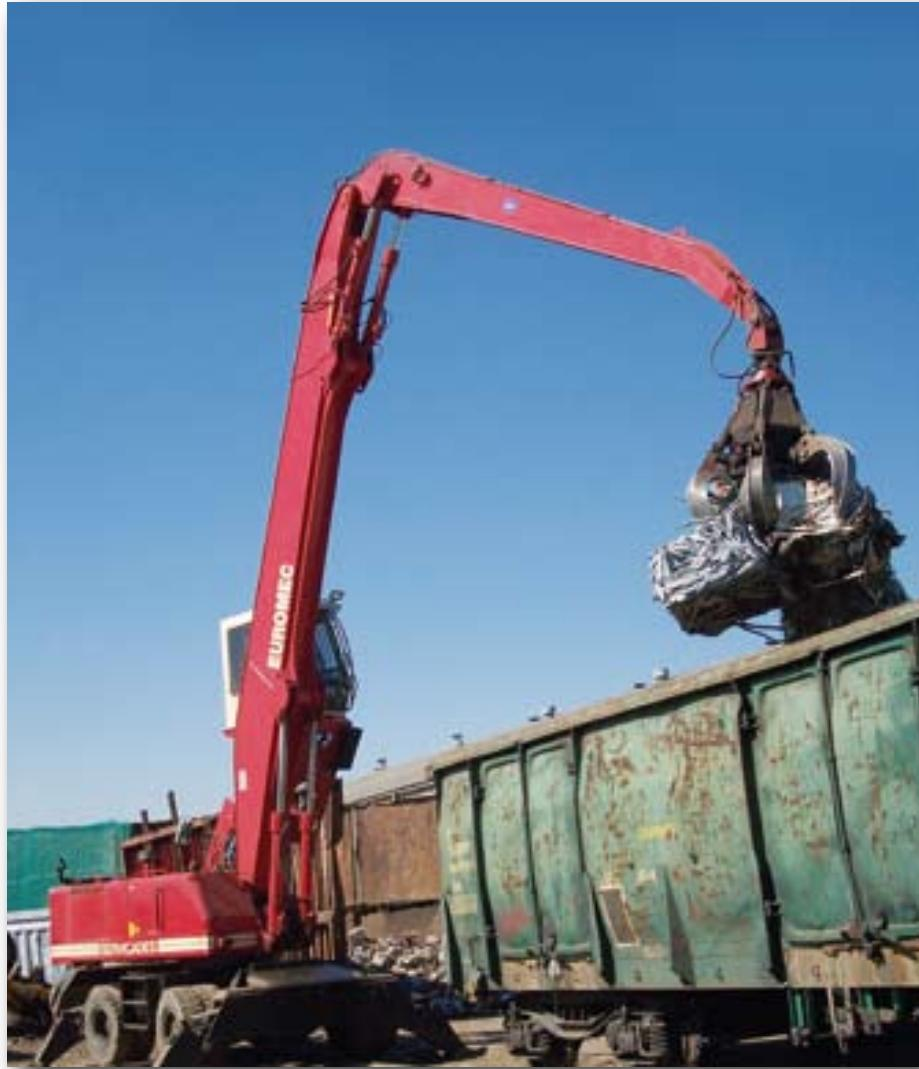
Caricatori semoventi idraulici gommati o cingolati.
