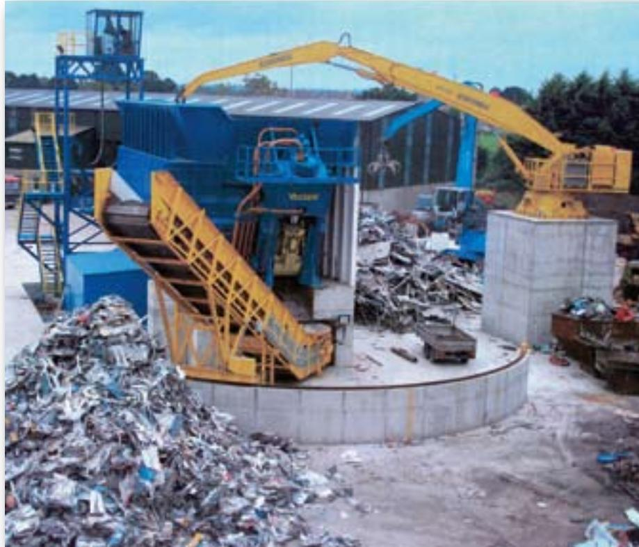
Grues fixes avec commandes à distance électro-hydrauliques proportionnelles, placées dans la cabine de la cisaille ou de la presse.
