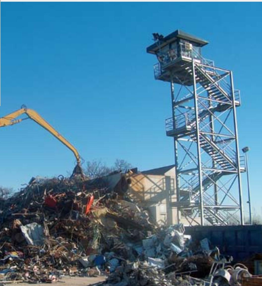
Grues fixes avec commandes à distance électro-hydrauliques proportionnelles dans la cabine de la cisaille ou de la presse.
