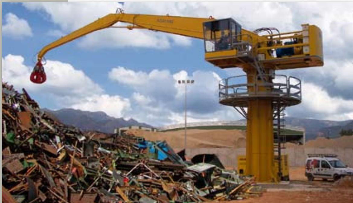
Gru fisse con funzionamento elettrico o diesel, con comandi sulla torretta girevole servo-assistiti. E' possibile trasferire nella cabina della gru anche i comandi per l'azionamento della cesoia, della presa, del mulino.
