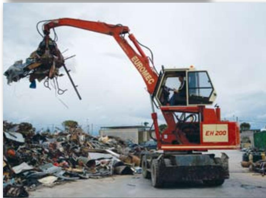
Caricatori semoventi idraulici.
