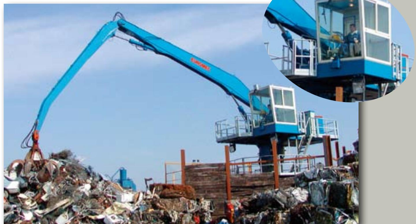
Gru fisse con funzionamento elettrico o diesel, con comandi sulla torretta girevole servo-assistiti per alimentazione mulini fino a 4500 CV.
