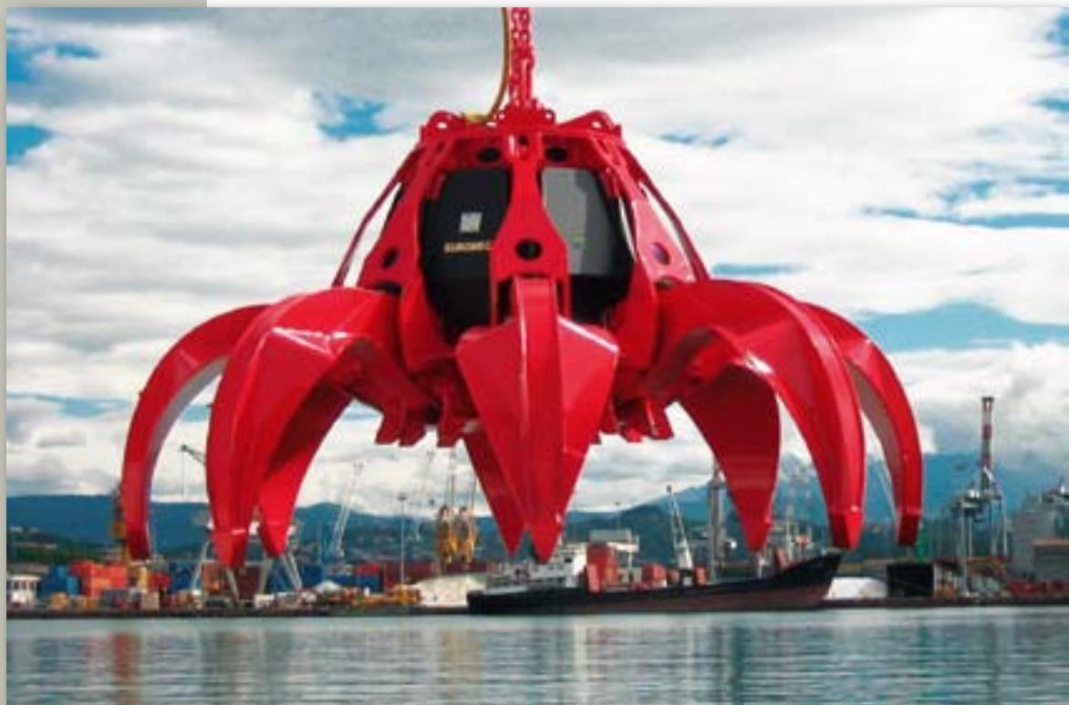
Polipi elettroidraulici per movimentazione di rottami metallici, scorie, massi e materiali alla rinfusa.
