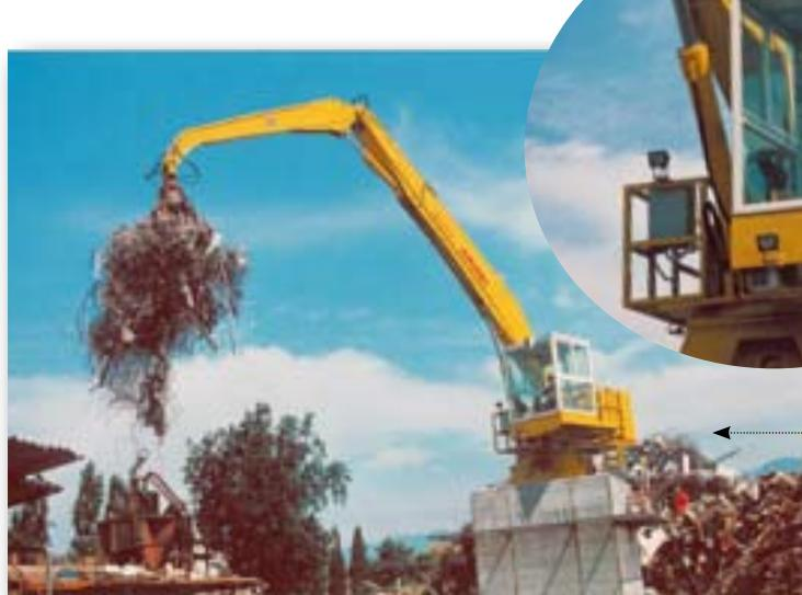
Gru fisse con doppi comandi elettro-idraulici proporzionali sia sulla torretta girevole, sia a distanza nella cabina della cesoia, della presa, del mulino.
