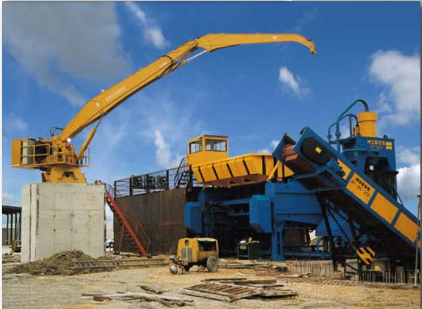
Gru fisse con comandi a distanza, elettro-idraulici proporzionali, posizionati nella cabina della cesoia o della pressa.
