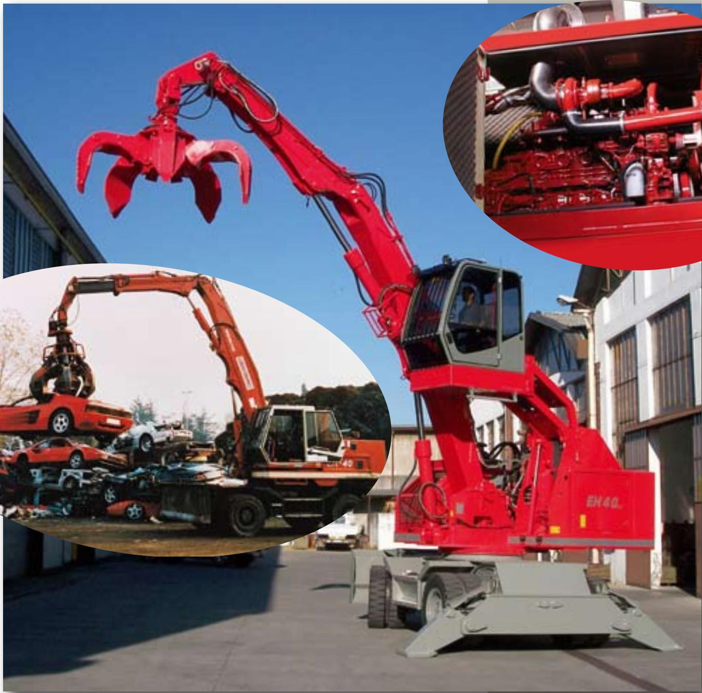
Caricatori semoventi idraulici.
