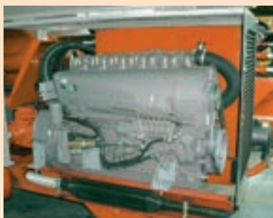
Gruppo motore con carter insonorizzato, raffreddamento ad aria Engine group with sound-proof casing, air cooled
